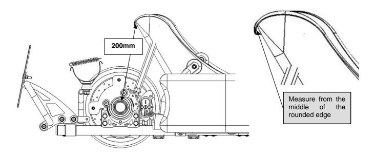
6-3 DISTANCE BETWEEN THE AXIS OF THE LEFT SIDE STUB AXLE FORK AND THE MIDDLE OF THE REAR ROUNDED EDGE OF THE SEAT.
