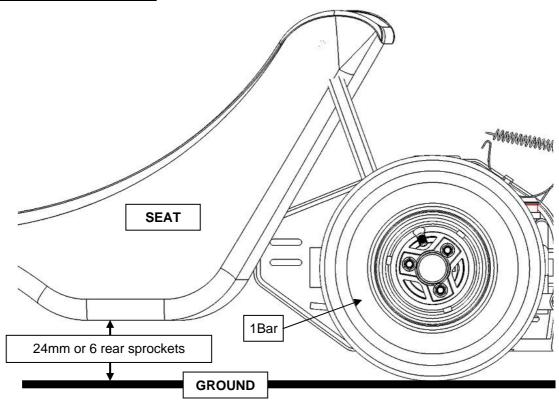
6-2 DISTANCE BETWEEN THE REAR AXLE AND THE MIDDLE OF THE ROUND REAR EDGE OF THE SEAT.
