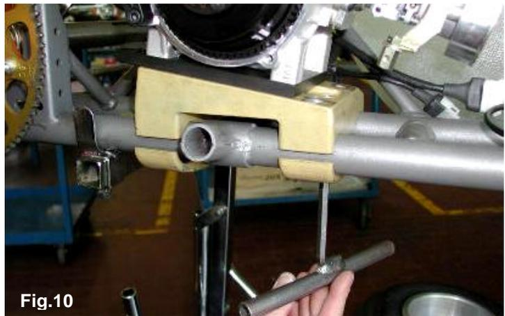
3.5.2 CHECK THE ALIGNMENT OF THE ENGINE SPROCKET AND THE AXLE SPROCKET WITH A STRAIGHT EDGE (SEE FIG. 11).
