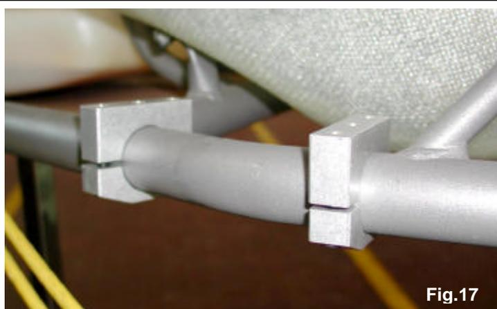
**3.7.3** POSITION THE BATTERY SUPPORT BOX ON THE CLAMPS MATCHING THE ATTACHMENT HOLES (SEE FIG. 18).
