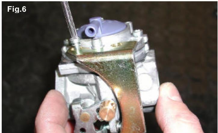
3.4.4 INSTALL THE INTAKE SUPPORT – 2 SCREWS M5 X10 (SEE FIG. 7)
